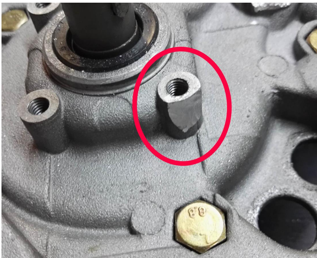
Modifica su colonnetta vite statore, in quanto si appoggia sulla bobina e blocca la rotazione.
